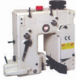
YAOHAN N980 AC Taiwan'dan ithal en yüksek kalite üründür. Devir 2700 R.P.M Yağ Banyolu - Malzeme kalınlığı 8mm Dikiş eni : 7-11,5mm Kasnak : 100mm
