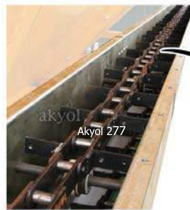
Vidalı kova iki kenarından takıp çıkarılan vidaları mevcuttur. Boydan boya çubuğu yoktur
