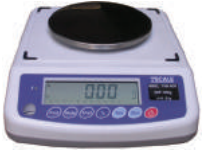
THB 600 0.01 gr. hassasiyetli terazi. (Gluten terazisi) Max. 600 gr. kapasite
