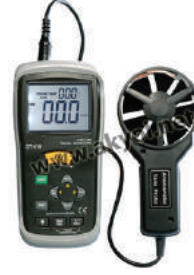
DT-619 RÜZGAR HIZI VE HAVA DEBİSİ ÖLÇER 0.4 ile 30.0 m/s. ölçüm aralığı
